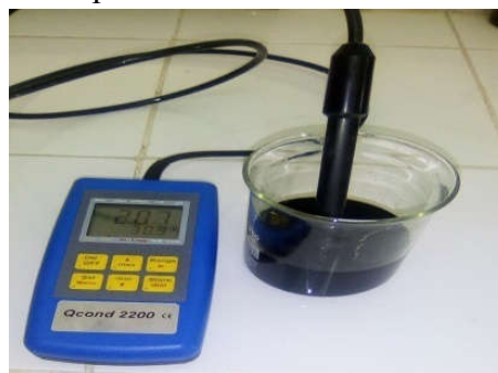
Figure 5 : Montage de mesure de la conductivité
