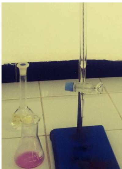
Figure IV.11 : la détermination d'Indice d'acide.
