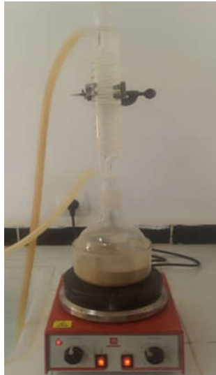
Figure IV.12 : détermination de l'Indice d'ester.
