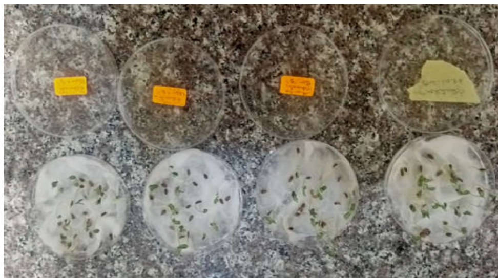
Figure V.5 : test de germination des grains de lin séchés par le lit fluidisé.
