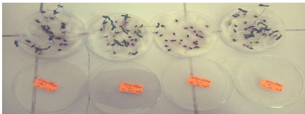
Figure V.6 : test de germination des grains de lin séchés par le micro-ondes.
