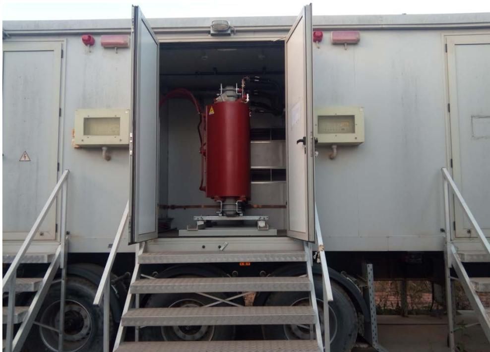
Figure : II. 6 Remorque d'alimentation électrique
