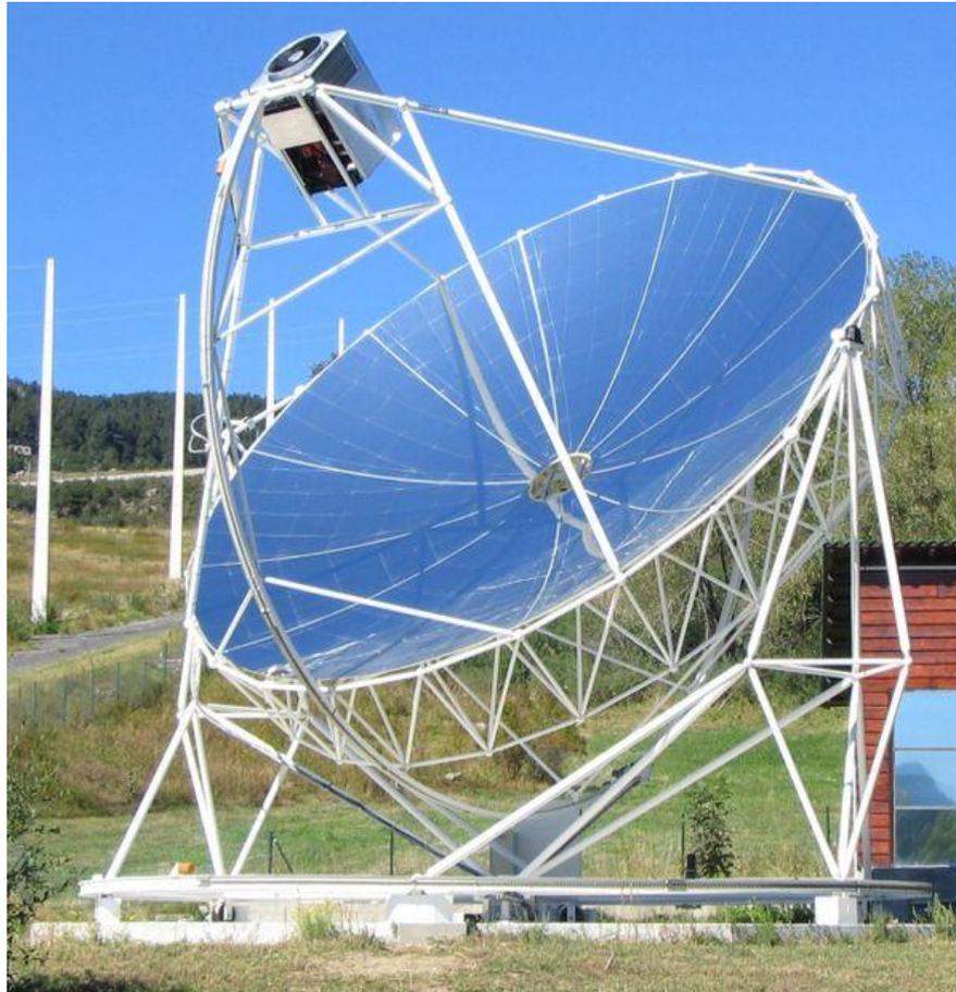
**Figure 11:** Capteur parabolique[37]
