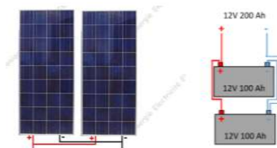
Figure 10 : deux Panneaux/ Batteries en parallèle .
