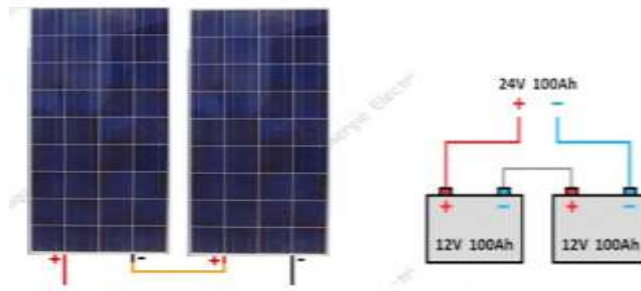
Figure 9: deux panneaux /batteries branché en série
