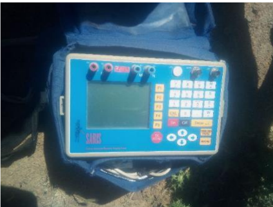
Figure.4.3 : Résistivimètre Saris de Scintrex
