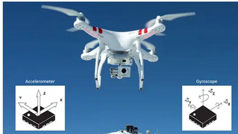
FIGURE 60 – Un drone avec deux capteurs, accéléromètre tridimensionnel et gyroscope 3D
