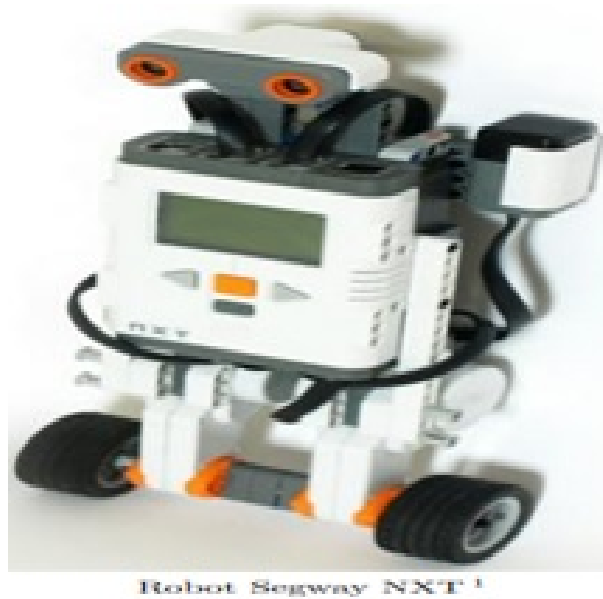
FIGURE 1.3 – Exemple de système mécanique sous actionnée : robot Segway
