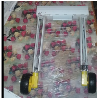
FIGURE 4.46 – Raccordement des deux roues avec le chassie
