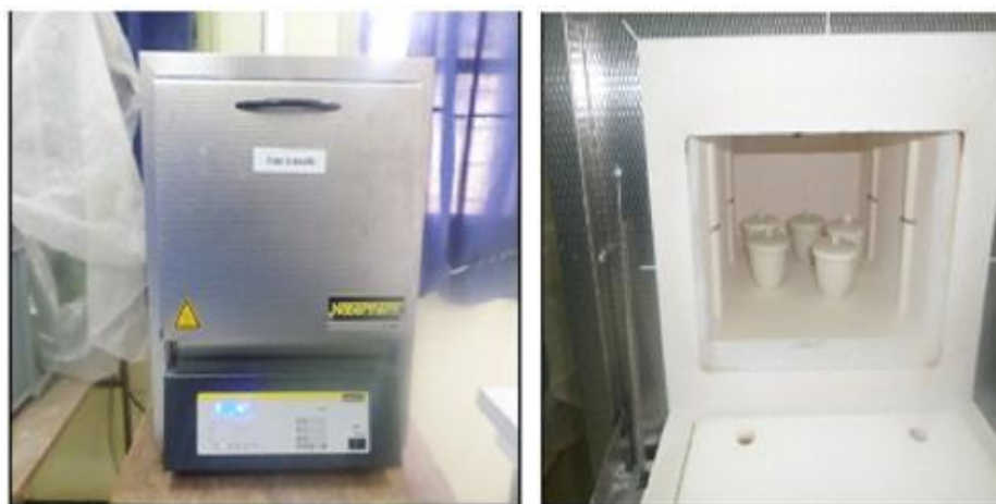
Figure IV .3 : Four à moufle utilisé dans l'activation du charbon actif.
