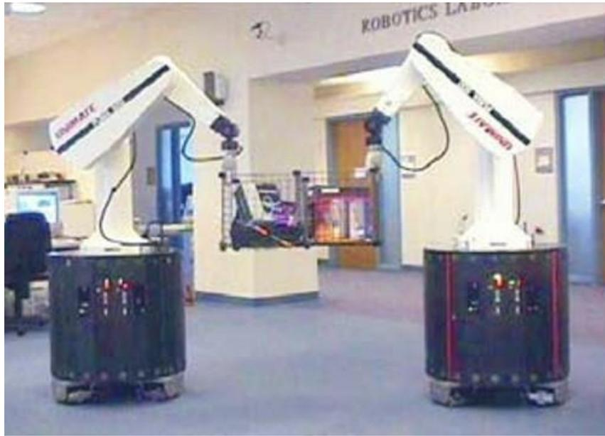
**Figure 1. 12.** Coopération de 2 PUMA 560 place sur des plateformes mobiles [23].
