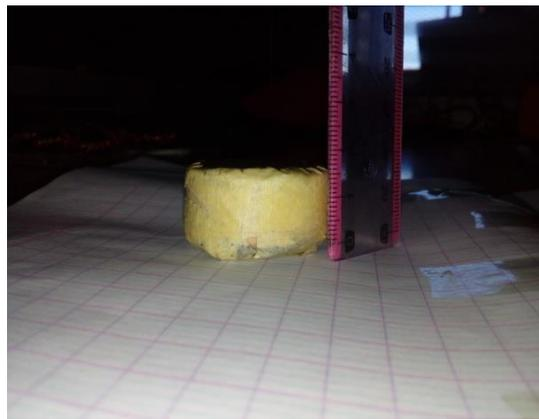
Figure III.1. Des pastilles supraconductrices YBCUO
