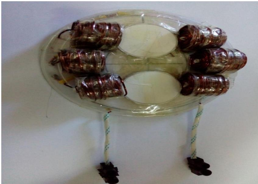
Figure III.3. Inducteur avec des bobines en cuivre vertical
