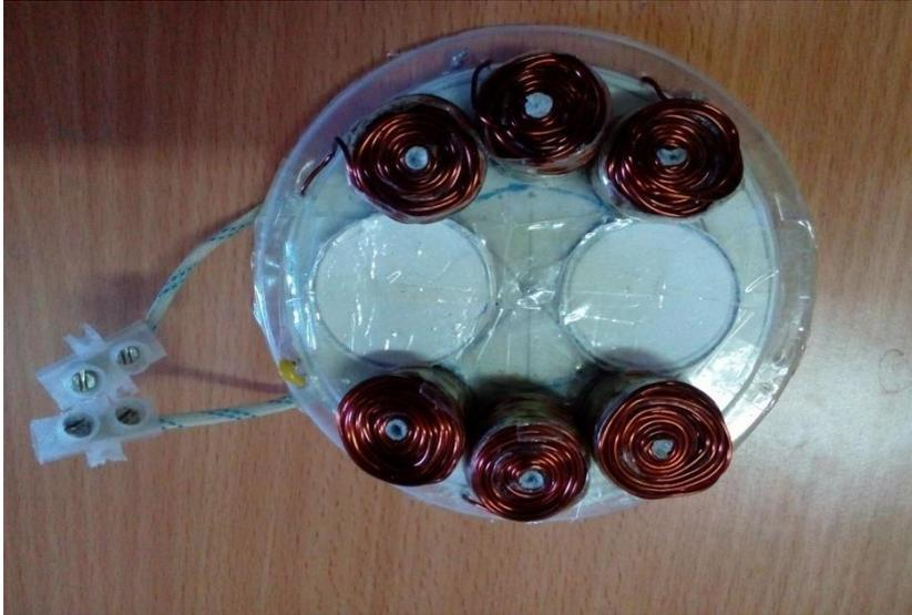
Figure III .2. Inducteur avec des bobines en cuivre horizontal
