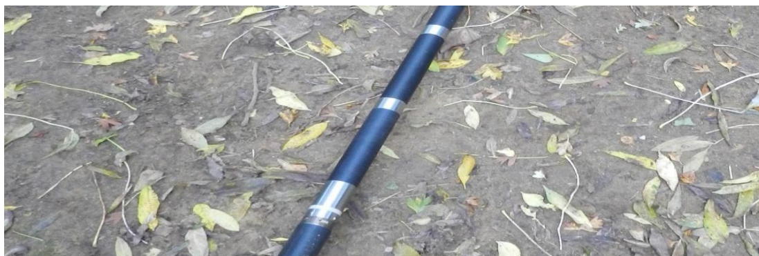
Figure III. 20 : Sonde de résistivité Normales "4 électrodes 8, 16, 32, 64", polarisation spontanée et gamma ray
