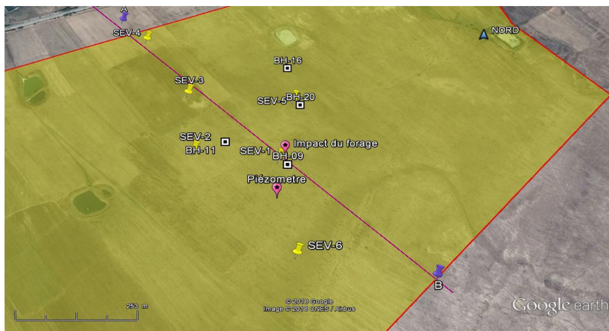
Figure III. 14 : Positionnement de la coupe géo électrique
