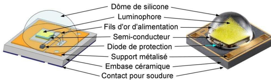
Figure I. 6 : Technologie d'une LED obtenue par dopage d'un semi-conducteur par dopage électronique [21]
