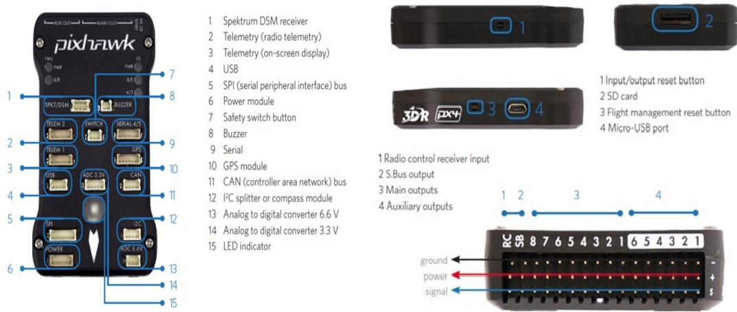
FIGURE 4.3 – Les Entrées/Sorties d'un PixHawk
