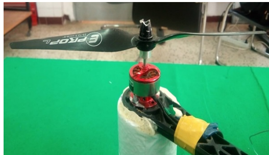
FIGURE 4.9 – Hélice avec moteur
