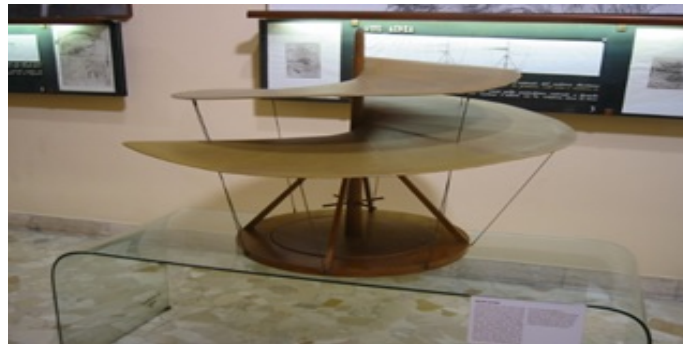
FIGURE 1.1 – Maquette de vis aérienne de Léonard de Vinci
