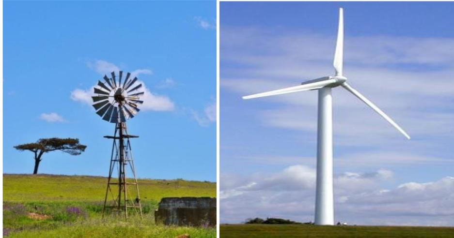
Figure I.5 : Les éoliennes à axe horizontal [8]
