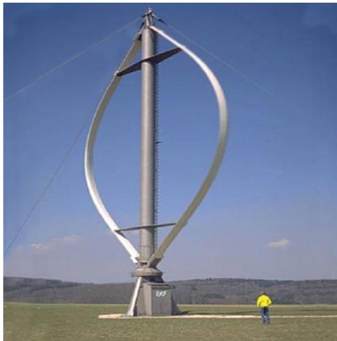
Figure I.3 : rotor de Darrieus[8]
