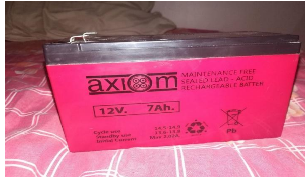
Figure III- 5 : batterie Acid 12 v 7Ah.
