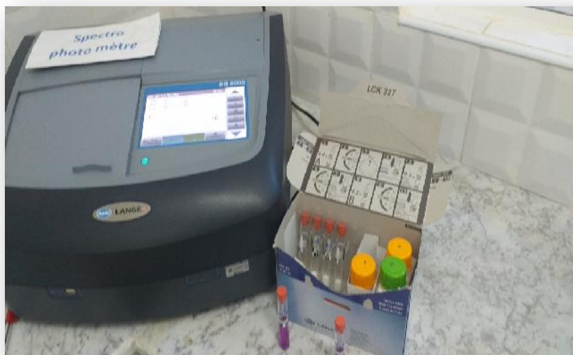
Photo 10 : Analyse de la dureté, calcium, magnésium LCK327
