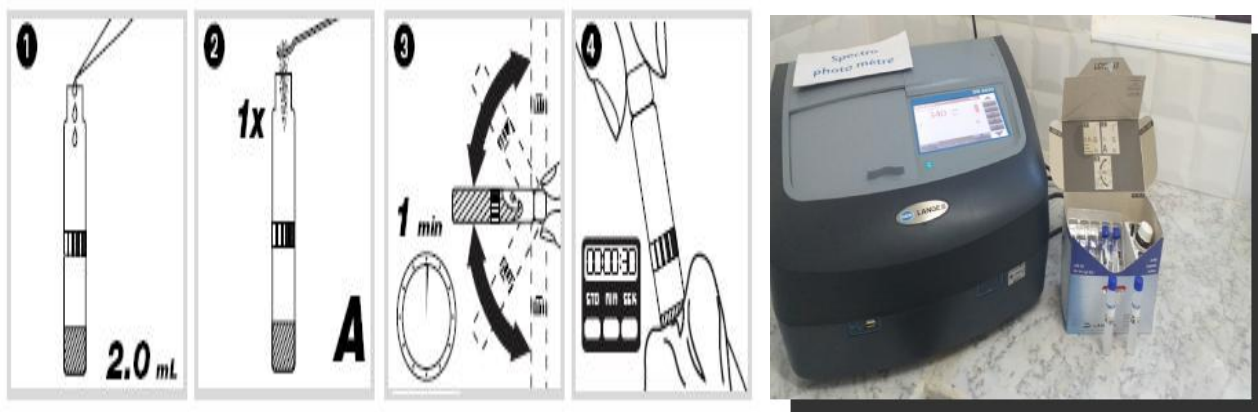
Photo9: Analyse des sulfates LCK
