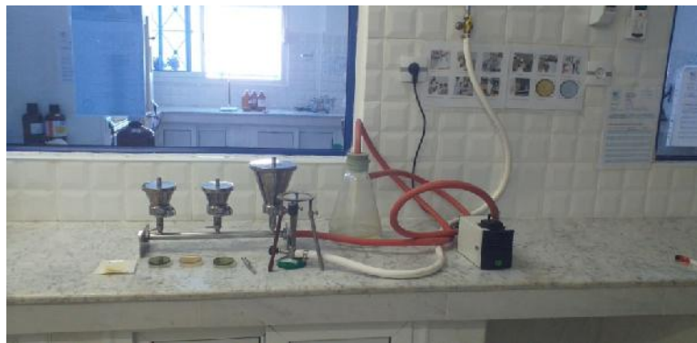
Rampe filtrante et bec benzène et boîtes de pétrie
