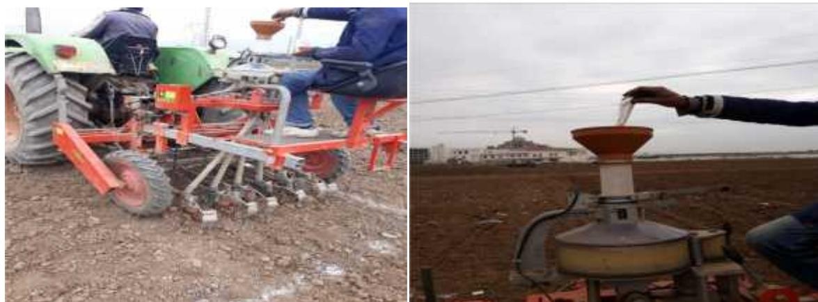
**Figure 15** : Semis à l'aide d'un semoir expérimental
