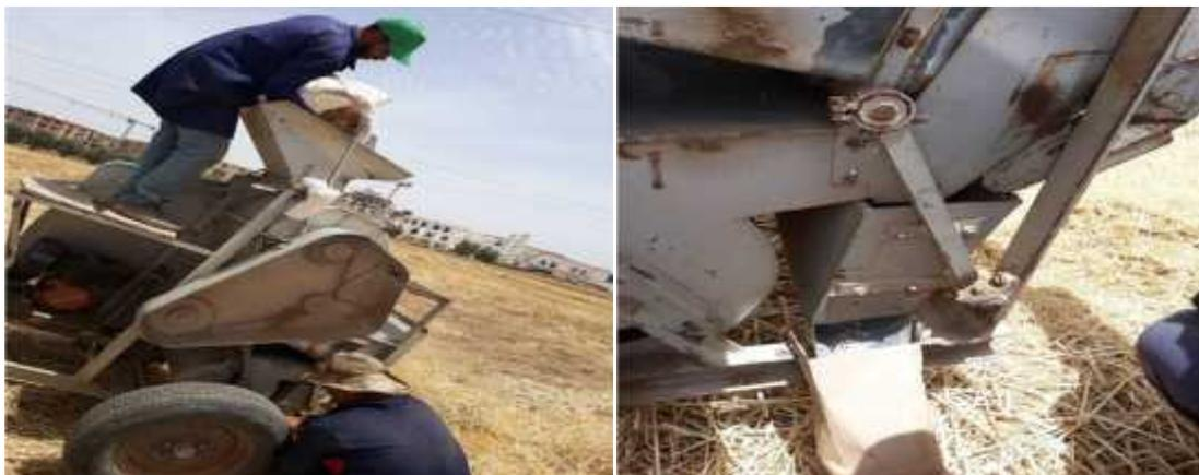
**Figure 26** : Batteuse à poste fixe
