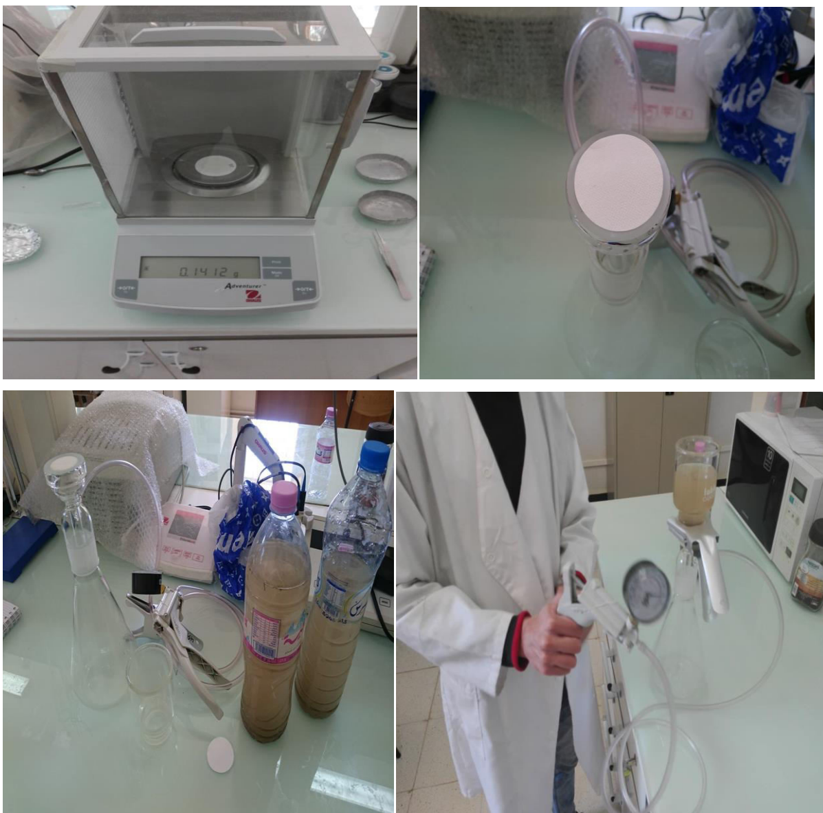
Figure N° 12: méthode de filtration avec une pompe à vide manuelle (cliché par Hamdoud et kelkouli,2019)
