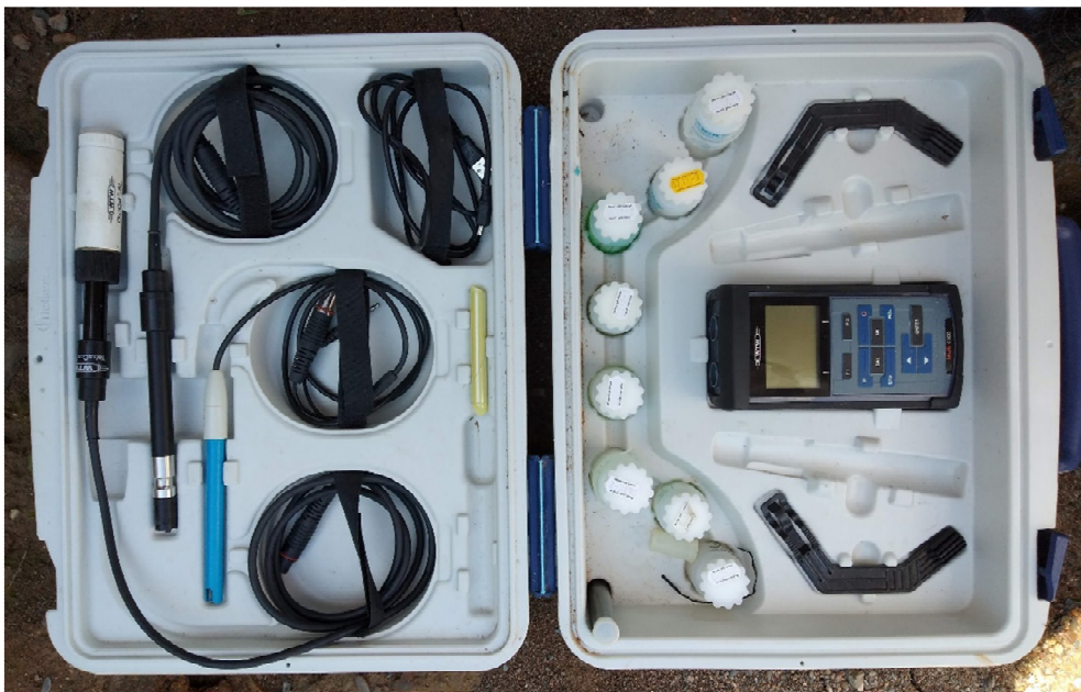
Figure 5. - Multiparamètre, modèle WTW. Multi 3320 SET 1
