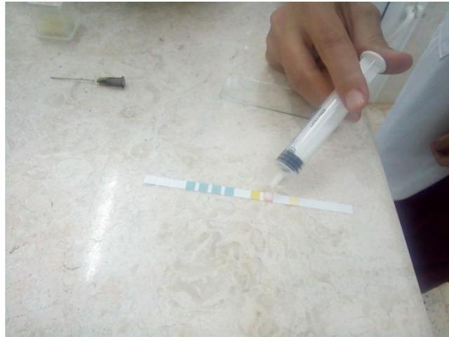
**Figure 23** : Mesure de pH de la laitance (Originale).
