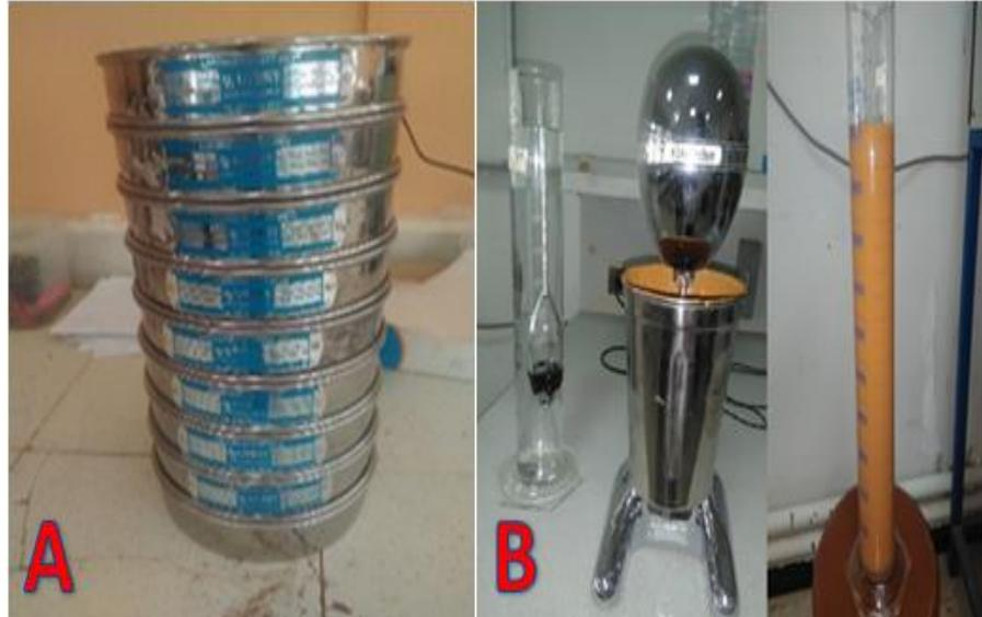
**Figure II.5** — Analyse granulométrique par tamisage(A) et Analyse de sédimentation (B)
