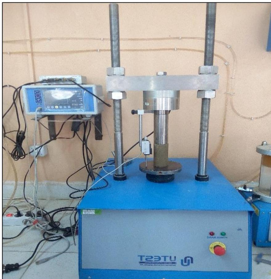
**Figure III.5 :** Essai de compression simple
