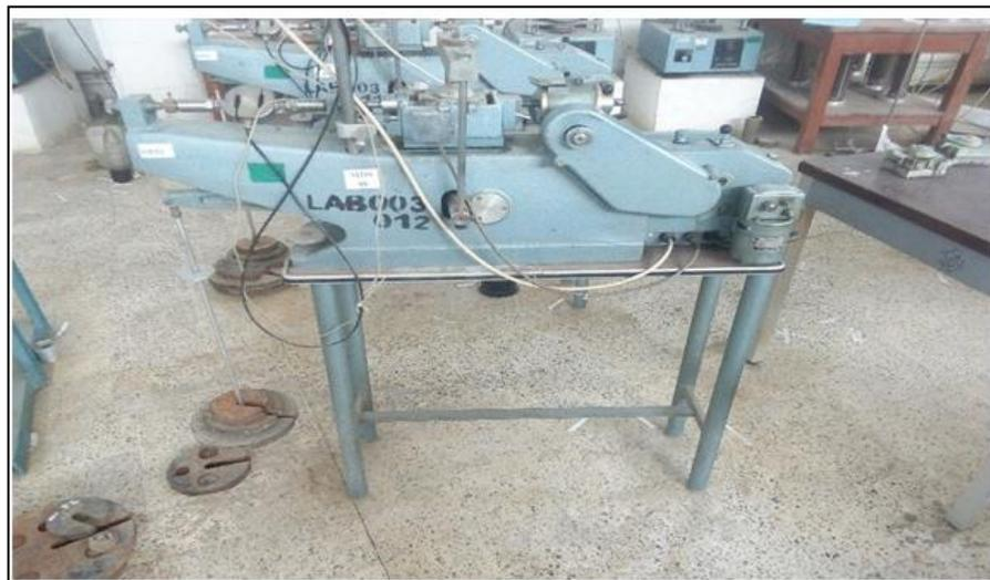
**Figure. III.9** Appareil de cisaillement direct
