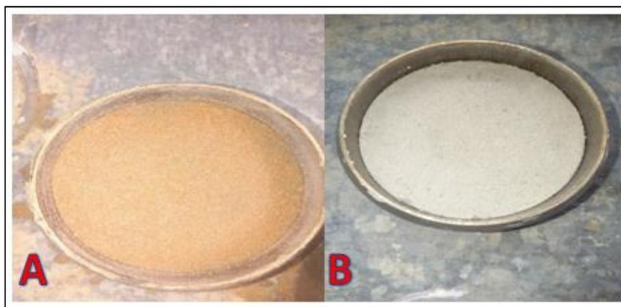
Figure. III.8. Surface rugueuse en béton (A) et surface lisse en béton (B)
