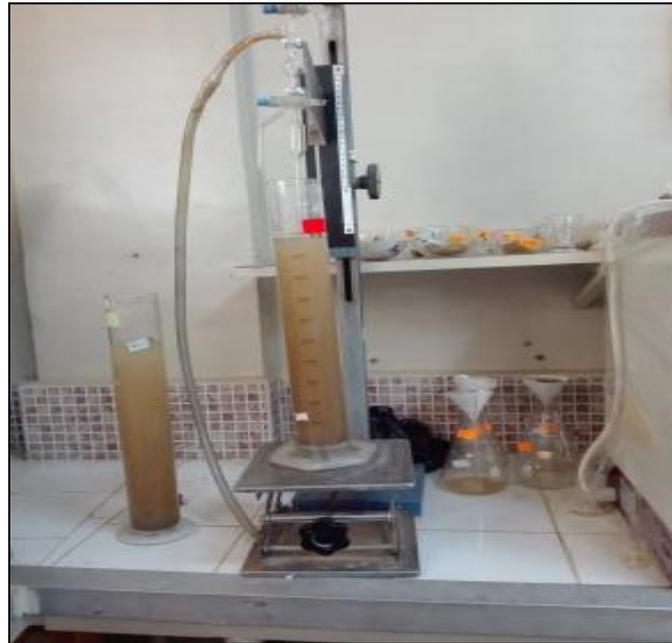
**Photo 9.** Analyse granulométrique avec pipette de Robinson (Crédit Touaibia et Harkat, 2019)
