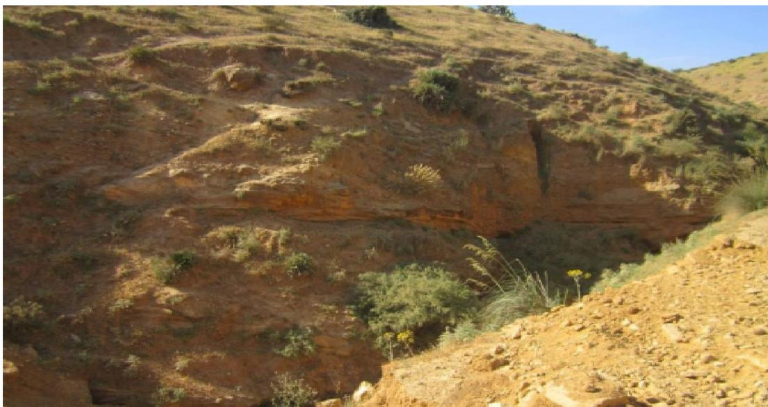
**Figure.2-9** : PK: 7+340 - Gravier de Miocène / Pliocène cimentés de CaCO<sub>3</sub>
