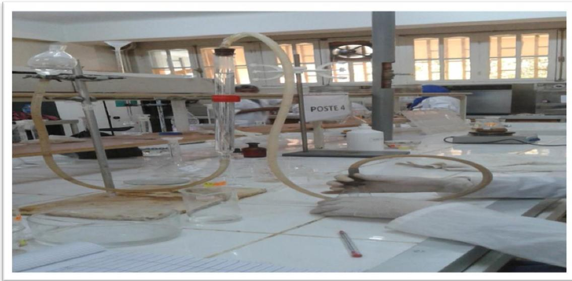
**Figure :** Dosage du calcaire total à l'aide d'un calcimètre de Bernard
