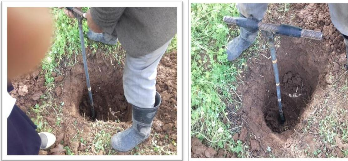
**Figure** : Méthode d'échantillonnage du sol à l'aide d'une tarière.
