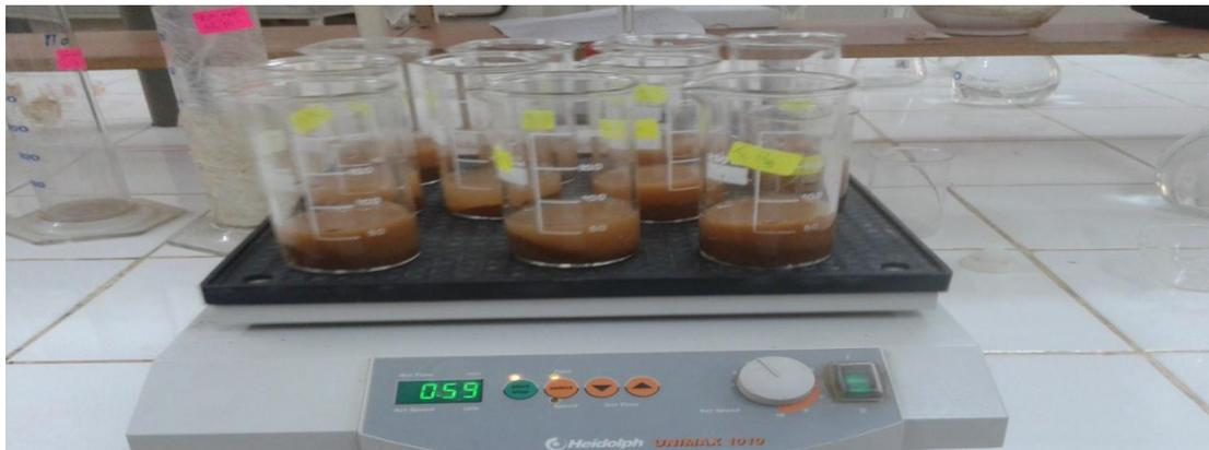
**Figure:** Mesure de la conductivité électrique
