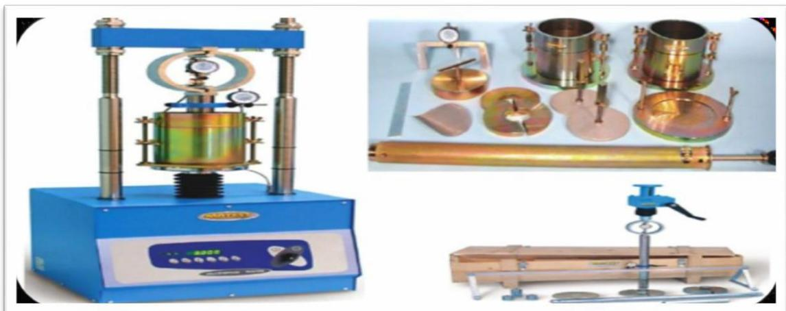
**Figure III.18** : Les appareils pour essai CBR
