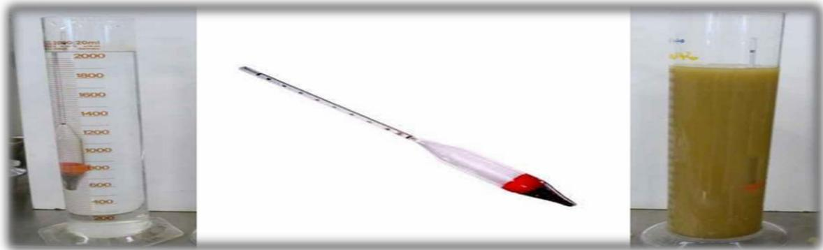
**Figure III.7 :** Appareillage pour l'essai de sédimentométrie.
