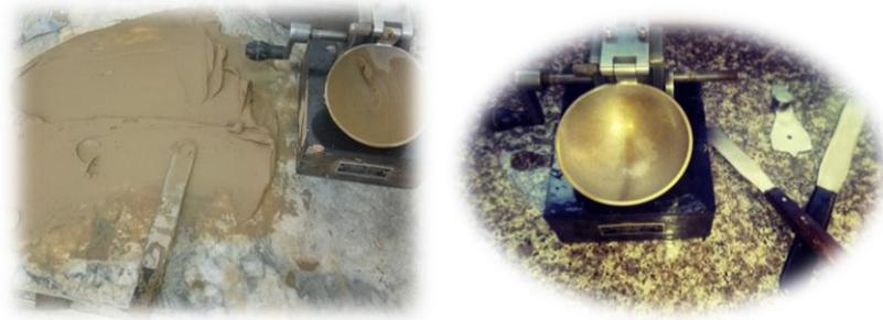
**Figure III.8 :** Essai de limite de liquidité
