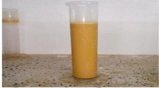
Essai granulométrique par tamisage et par sedimentométrie
