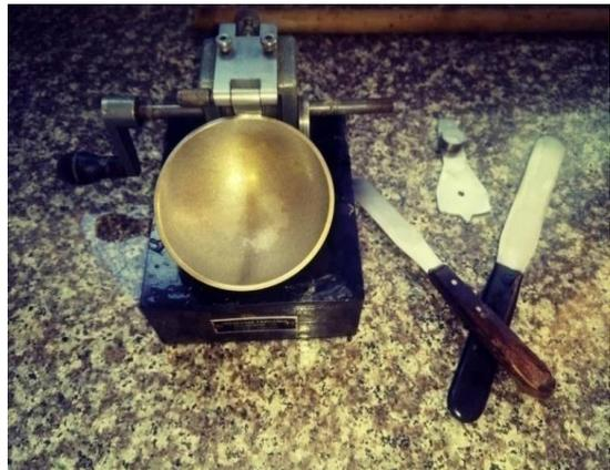
Essai des limites d'atterberg avec la coupelle de casagrande
