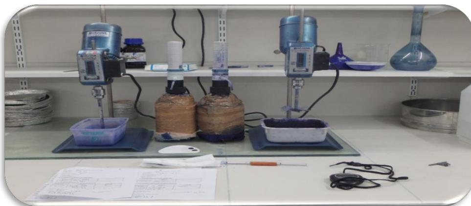
**Figure III.10 :** Les appareils pour l'essai de valeur au bleu de méthylène du sol
