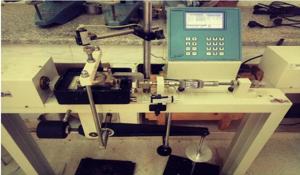
**Figure III.19 :** Appareil pour l'essai de cisaillement.
