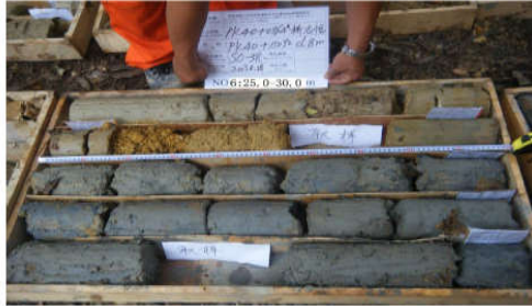
Sondage N°: SO-38 Marne intensesment altérée 25.0-30.0m
