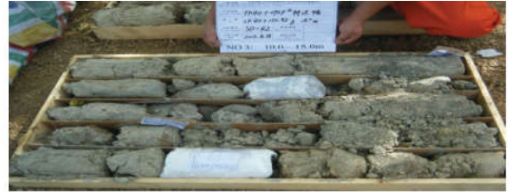
Sondage N°: SO-42 Marnes totalement altérées 10.0-15.0m
