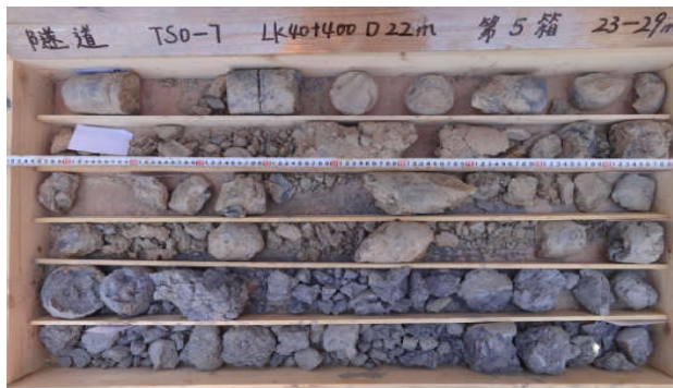
Sondage N°: TSO-7 Mame faiblement altérée 23.0-26.9m
