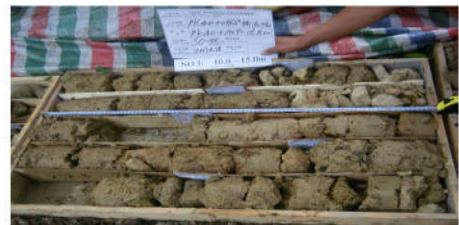
Sondage N°: SO-38 Mame totalement altérée 10.0-15.0m
