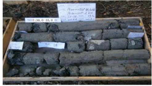
Sondage N°: SO-38 Marne intensesment altérée 30.0-35.0m
