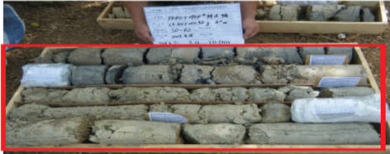
Sondage N°: SO-42 Marnes totalement altérées 6.5-10.0m
