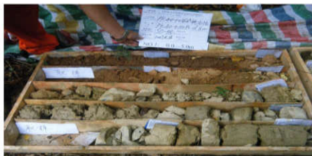
Sondage N°: SO-38 Argile peu plastique 0-2.1m
