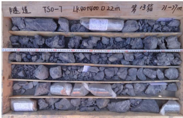
Sondage N°: TSO-7 Mame faiblement altérée 71.0-77.0m
