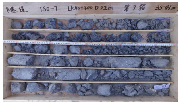
Sondage N°: TSO-7 Mame intensement altérée 35.0-41.0m
