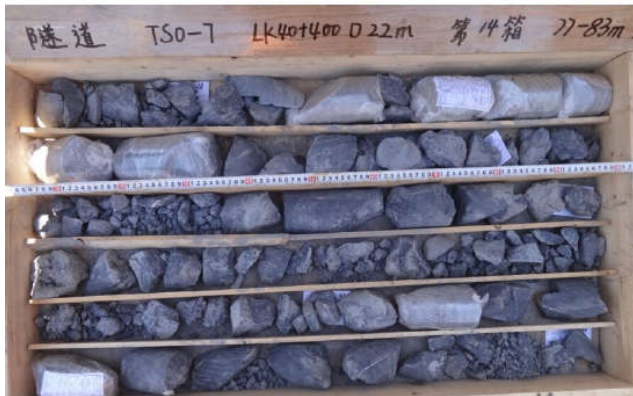
Sondage N°: TSO-7 Mame faiblement altérée 77.0-83.0m
