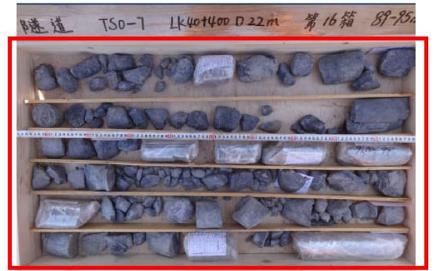
Sondage N°: TSO-7 Mame faiblement altérée 89.0-95.0m
