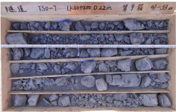
Sondage N°: TSO-7 Mame faiblement altérée 49.1-53.0m
