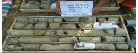
Sondage N°: SO-42 Marnes totalement altérées 15.0-20.0m
