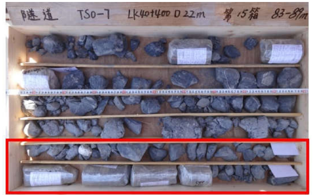
Sondage N°: TSO-7 Mame faiblement altérée 83.0-89.0m
