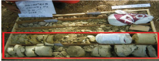
Sondage N°: SO-42 Argile peu plastique 0-6.5m
