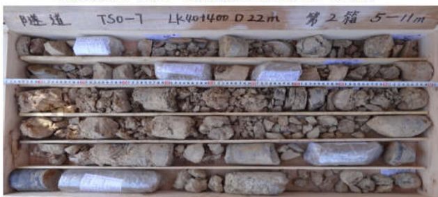
Sondage N°: TSO-7 Marne faiblement altérée 5.0-8.9m
