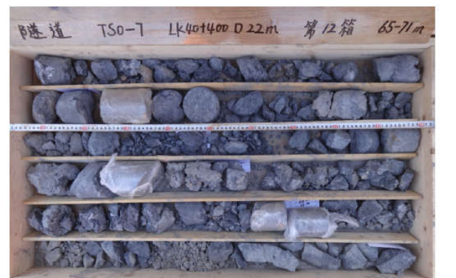
Sondage N°: TSO-7 Mame faiblement altérée 65.0-71.0m
