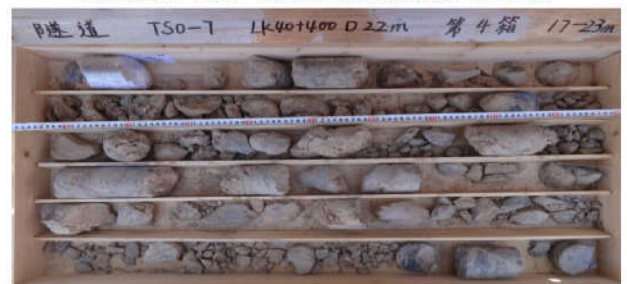
Sondage N°: TSO-7 Marne faiblement altérée 17.0-23.0m
