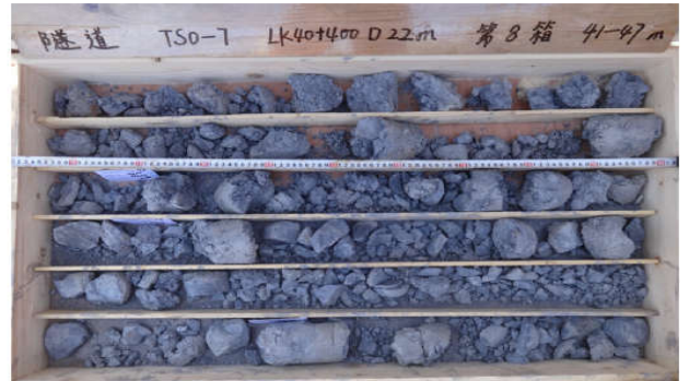
Sondage N°: TSO-7 Mame intensement altérée 41.0-49.1m
