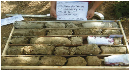
Sondage N°: SO-42 Marnes totalement altérées 20.0-28.2m
