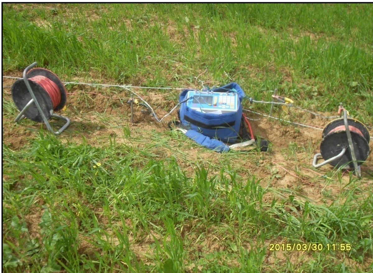
Figure 15: Le matériel utilisé pour l'acquisition des sondages électriques verticaux (SEV).
