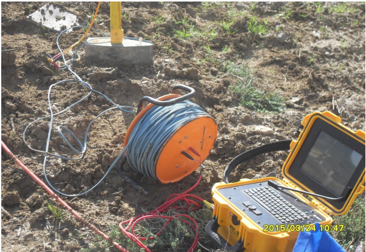
Figure 16: Le matériel utilisé pour la réalisation des profils sismiques
