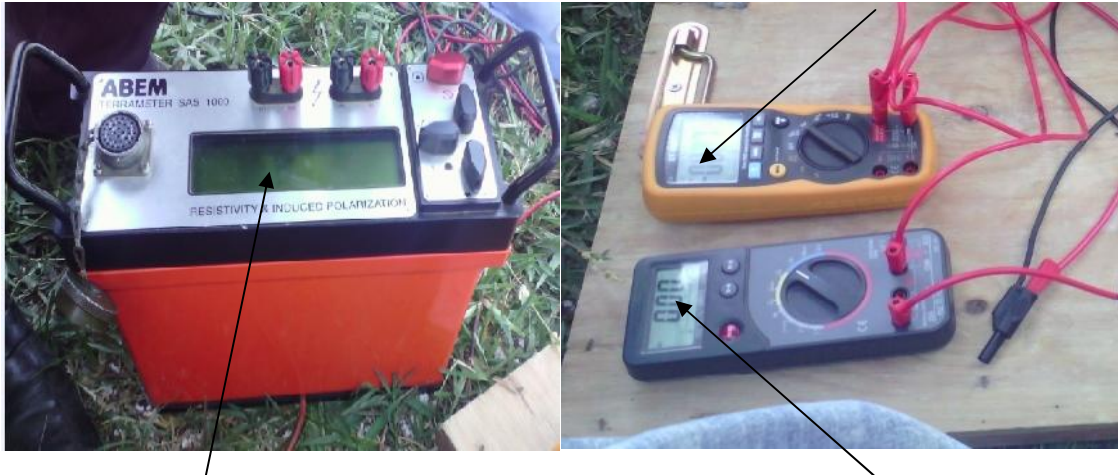
Figure III.4 : Photo de la mesure directe de la résistance donnée par ABEM et la mesure indirecte de notre maquette basée sur la loi d'Ohm.
