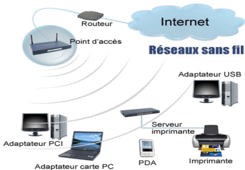
Figure 2. 14 : Principe de fonctionnement de wifi.
