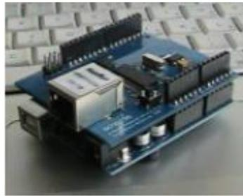
Figure II.3 Une carte Arduino étendue avec un Ethernet shield
