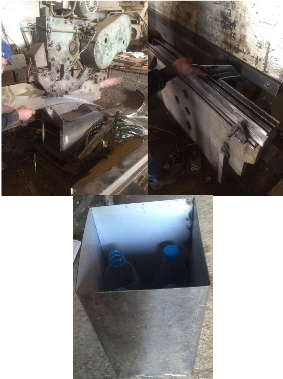
Figure 3.9 : méthode de formage de la boite en aluminium (extérieur de l'Inox)
