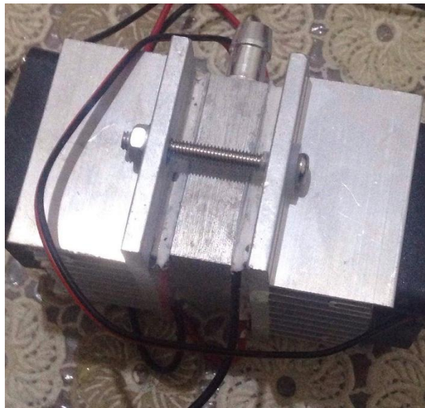
Figure 3.13 : Bloc de réfrigération (avec double module Peltier)
