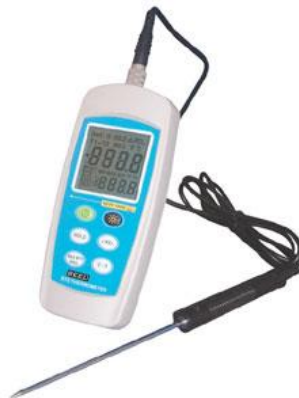
Figure 4.2 : Thermocouple a sonde métallique
