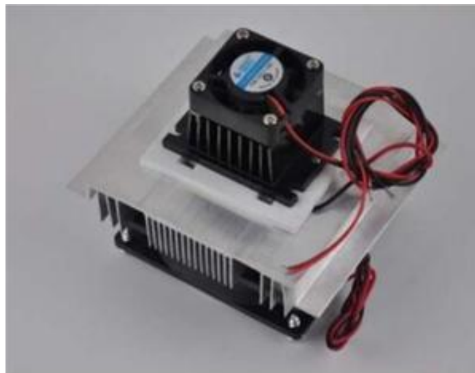
Figure 3.8 : module Peltier avec deux ailettes
