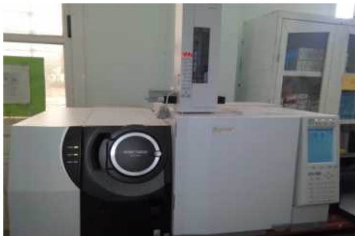
Figure 1V.7 : Appareil de chromatographie en Phase Gazeuse Couplée à la spectrophotométrie de masse.
