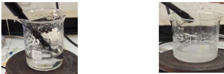
**Figure III.10.** Image de la dernière phase de préparation du gel à la base du triéthanolamine (à gauche) et l'image de la dernière phase de préparation du gel à la base du NaOH (à droite).
