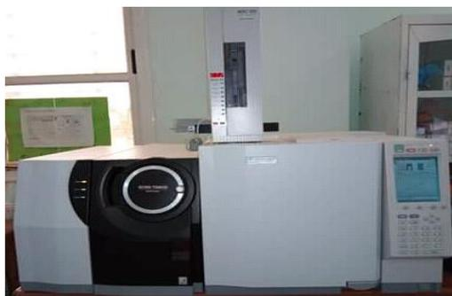
**Figure III.6.** Photo de l'appareil de la chromatographie en phase gazeuse (CPG) couplée avec la spectrométrie de masse (SM).
