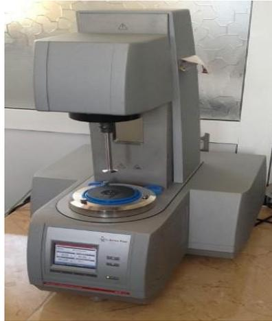
**Figure II.4.** Rhéomètre à contrainte imposée de type Antan Paar MCR 302.
