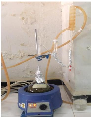
**Figure III.1.** Photo de l'hydrodistillateur de type Clevenger pour l'extraction de l'huile essentielle de *Thymus*.
