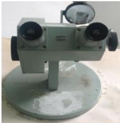
**Figure III.3.** Photo de l'appareil du réfractomètre.
