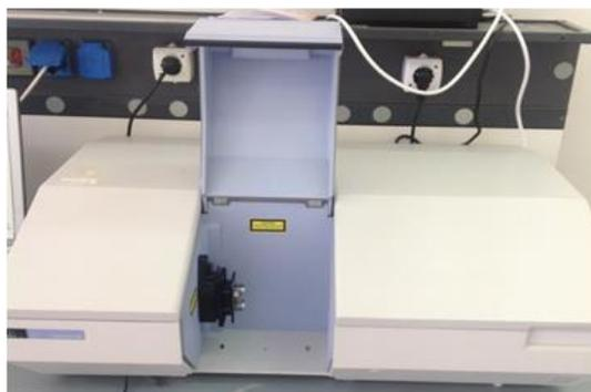
**Figure III.5.** Photo de l'appareil de l'infra-rouge (IR).
