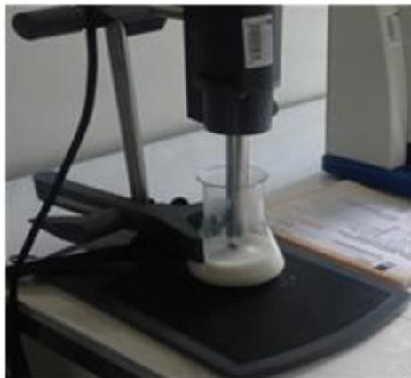
**Figure III.11.** Photo de l'appareil de l'homogenisateur.
