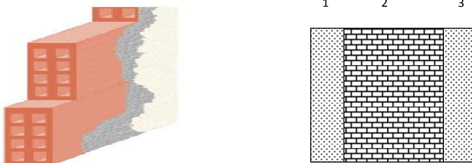
Figure II.10. Détail mur intérieur.
