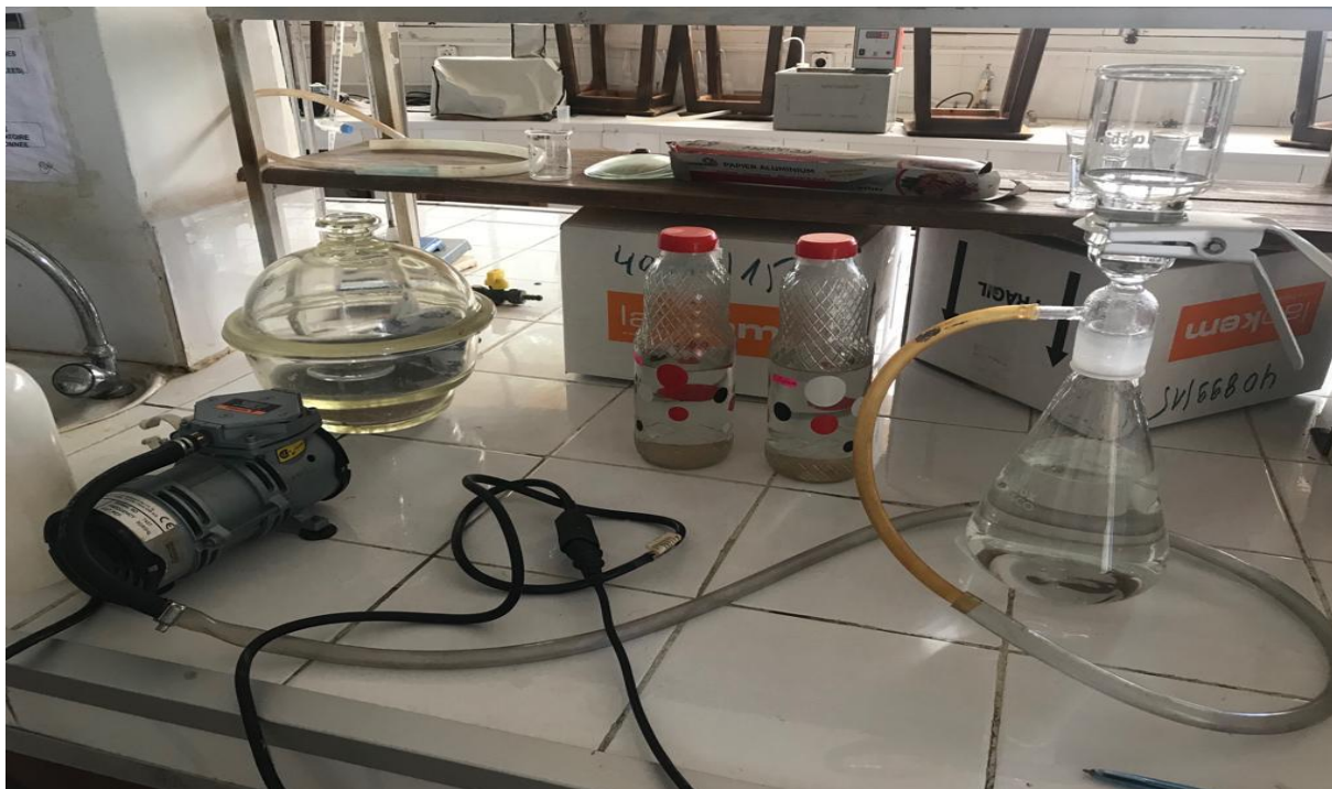
Figure 4. 3 : Dispositif de la filtration sous vide
