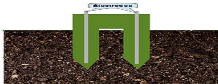
Figure 39 : Les électrodes de capteur d'humidité dans le sol
