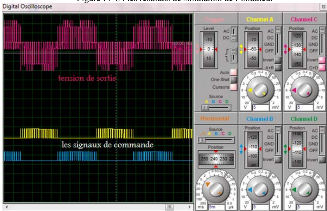
Figure IV-9: tension de sortie de l'onduleur et leurs deux signaux de commande par Arduino
