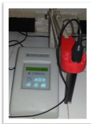
**Figure 6 :** appareil de pH mètre
