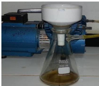
Figure III. 1: système de filtration
