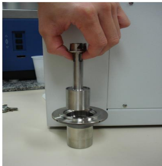
Figure III.7 : géométrie de mesure à double entrefer
