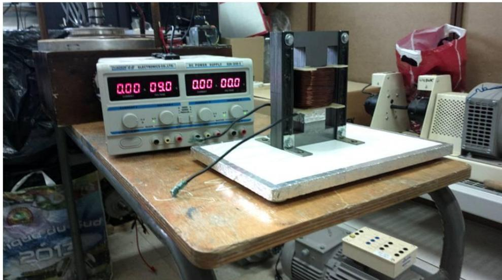
**Figure IV.9:** GCC d'alimentation avec le circuit magnétique
