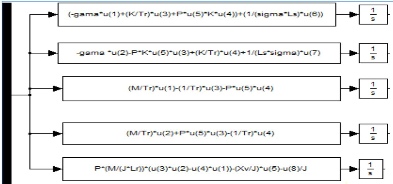
Fig.III.5 Schéma modèle simulation du moteur à induction sur Matlab
