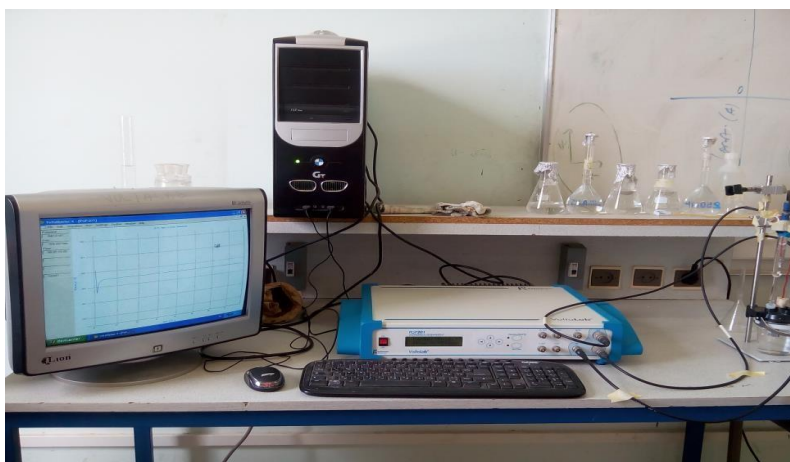
Figure III.2. Image photographique du potentiostat/Galvanostat voltalab21, utilisé.
