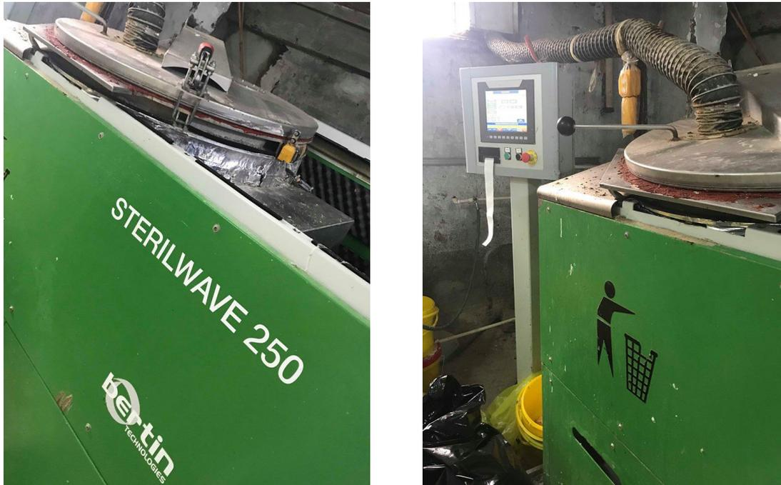
Photo n°15 : Le banaliseur installé au niveau de l'EPH (sterilwave 250)
