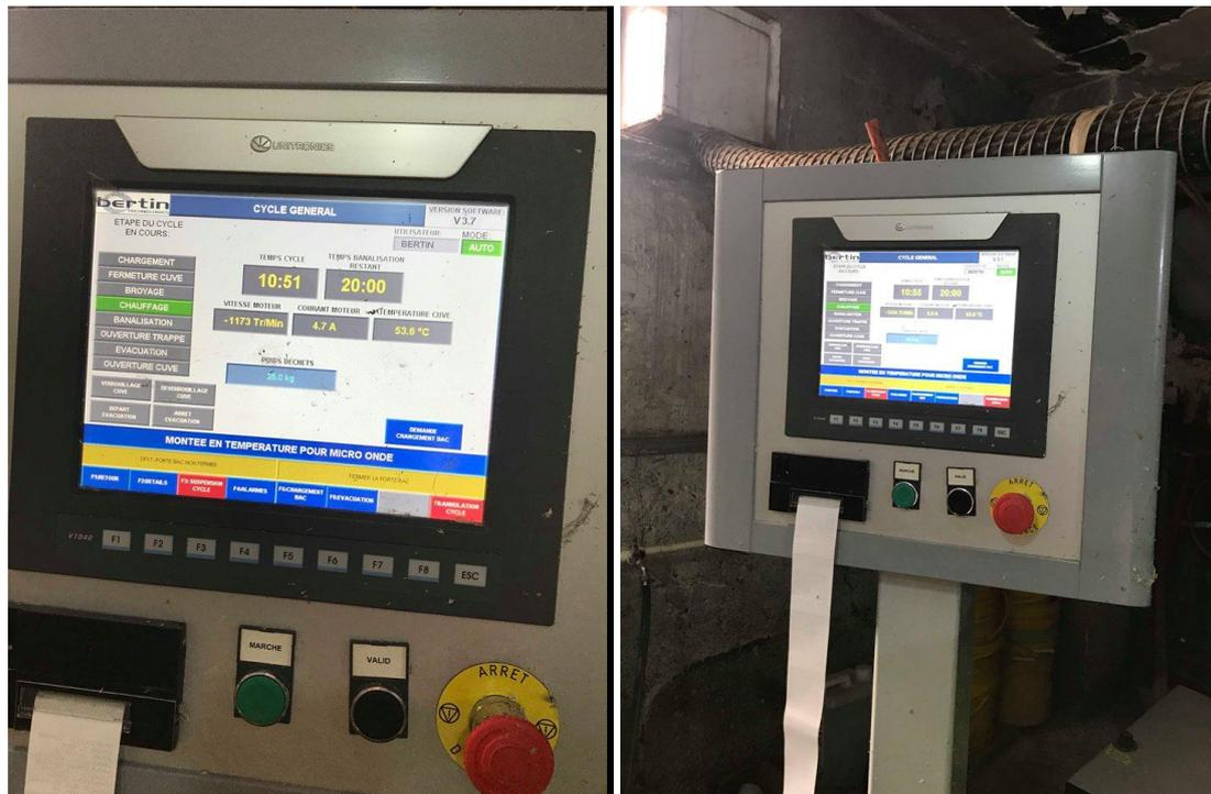
Photo n°16 : L'IHM de commande du banaliseuse
