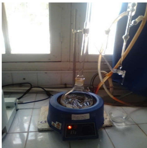
Figure 20 : Hydrodistillateur de type Clevenger
