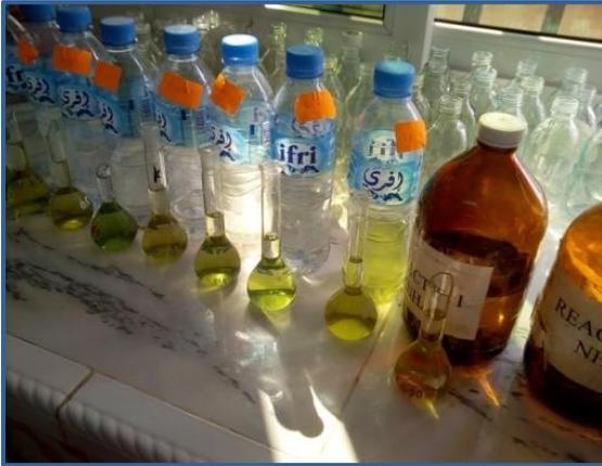
Figure 18 : Dosage d'ammonium avec réactif 1 et 2
