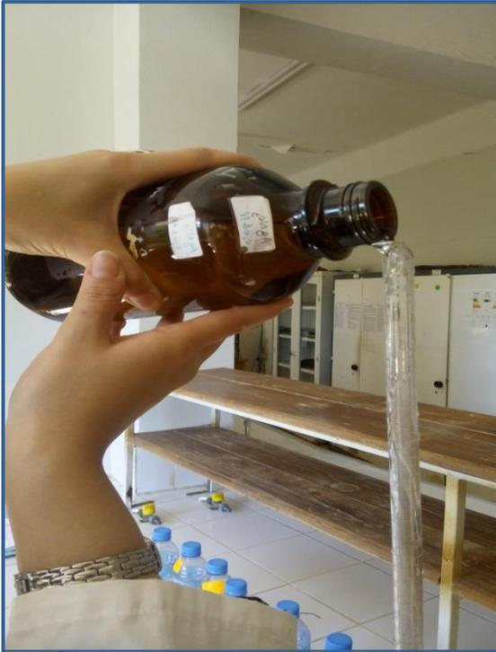
Figure 29 : Titrage par les nitrate d'argent
