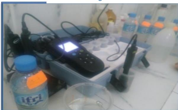
Figure 4 : Cliché d'un multi paramètre au laboratoire de l'ONID
