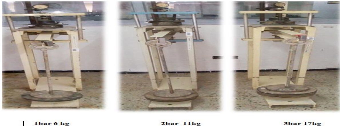
Figure IV.8: Matériel utilisé dans consolidation pour l'essai cisaillement type « CD ».
