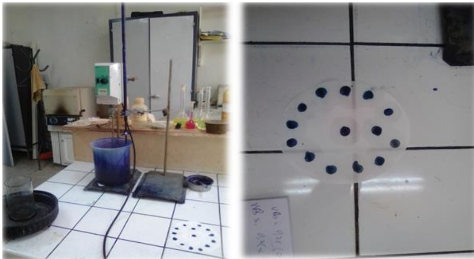
Figure III.8: Ensembles du matériel d'essai (Agitateur et papier filtre)
