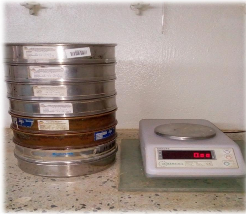
Figure III.4 : Appareillage d'essai granulométrique (tamiseuse et balance)
