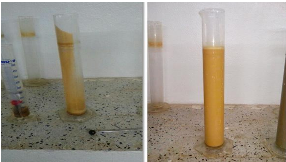
Figure III.5 : L'appareillage d'essai sédimentométrie (éprouvette cylindrique de 2 litres et agitateur)
