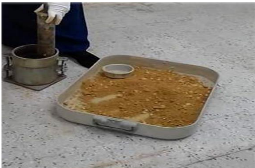
Figure IV.1: représente l'échantillon dans le moule Proctor.
