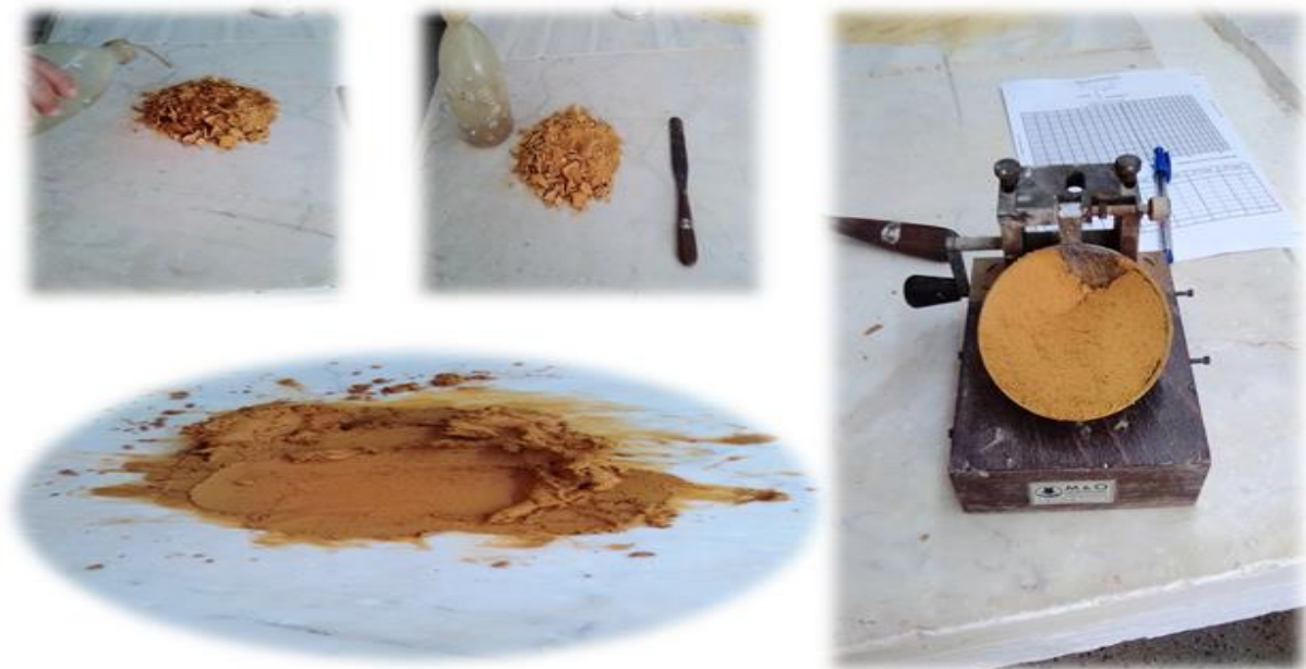
Figure III.9: Appareil de Casagrande avec la préparation de l'échantillon
