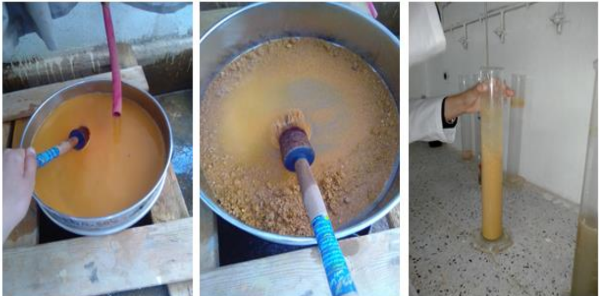
Annexe 17: lavage du matériau pour l'essai granulométrie et sédimentométrie
