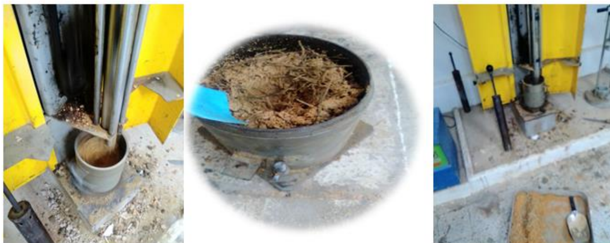
Figure IV.3: le matériel utilisé dans l'essai CBR.
