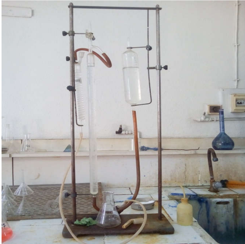
Figure 22 : Le calcimètre utilisé pour l'essai de la teneur en carbonate de calcium.
