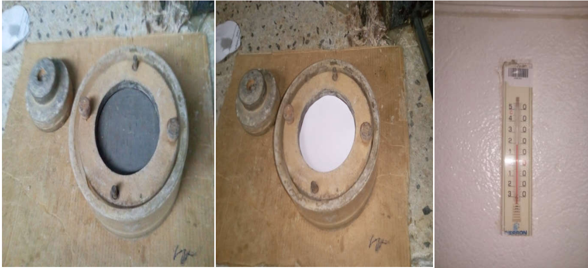
Figure 19 : Préparation de la cellule œdométrique pour l'essai de gonflement libre.
