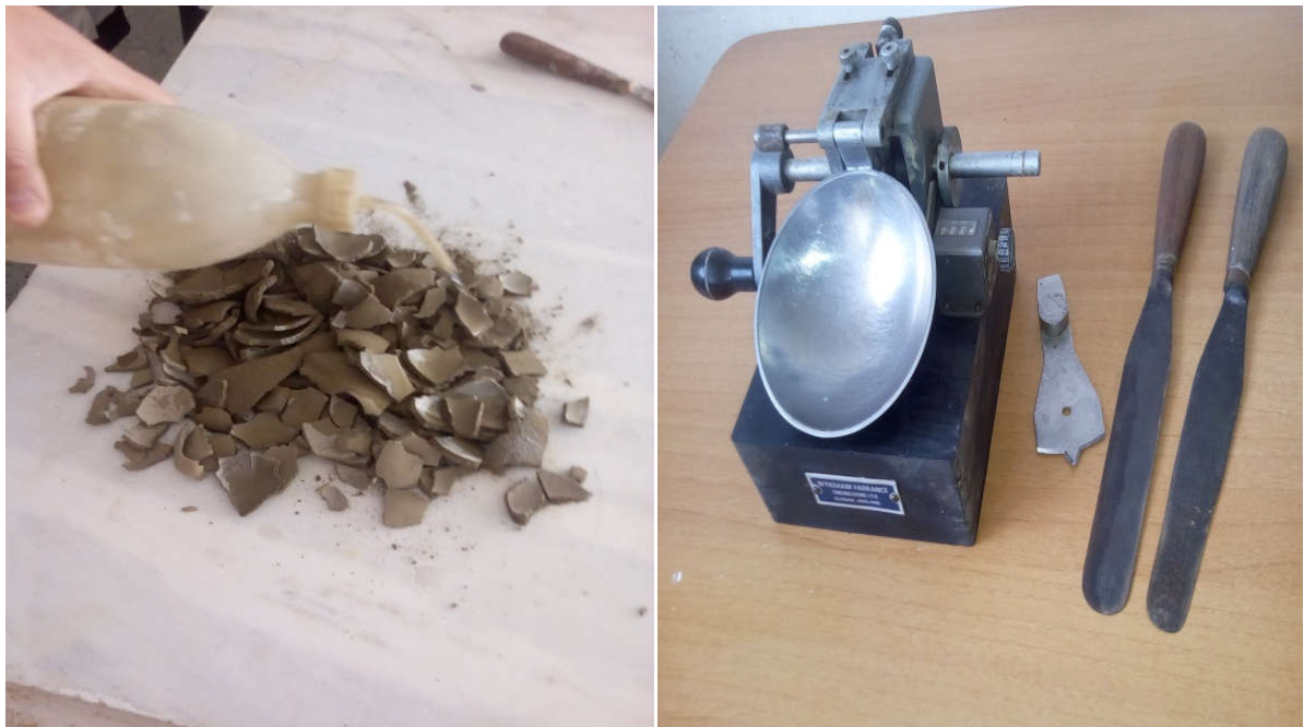
Figure 16 : Détermination de la limite de liquidité en utilisant la coupelle de Casagrande.
