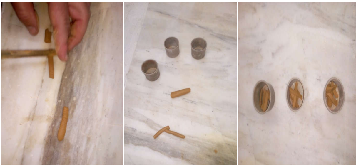
Figure 17 : Détermination de la limite de plasticité.
