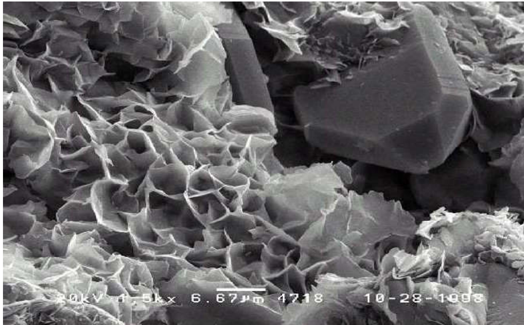
Figure 03 : Structure de la montmorillonite en vue microscopique au MEB, (Bougeois, 2015).
