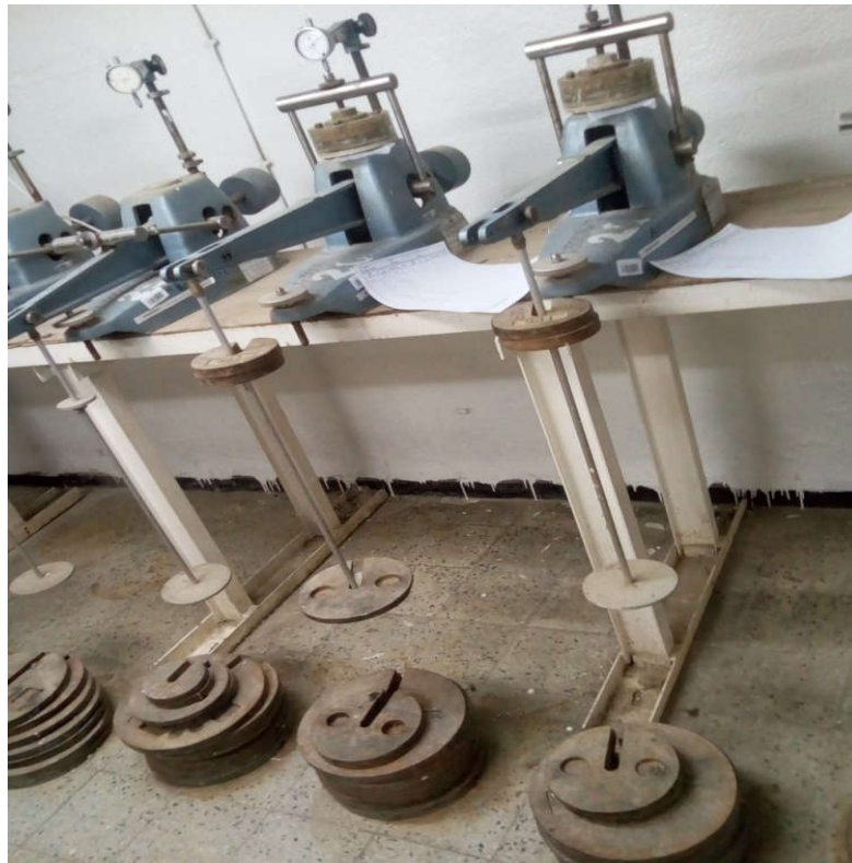
Figure 20 : Déroulement de l'essai de gonflement libre.
