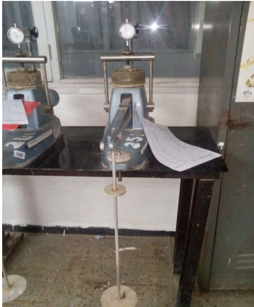
Figure 21 : L'essai de compression simple à l'œdomètre.
