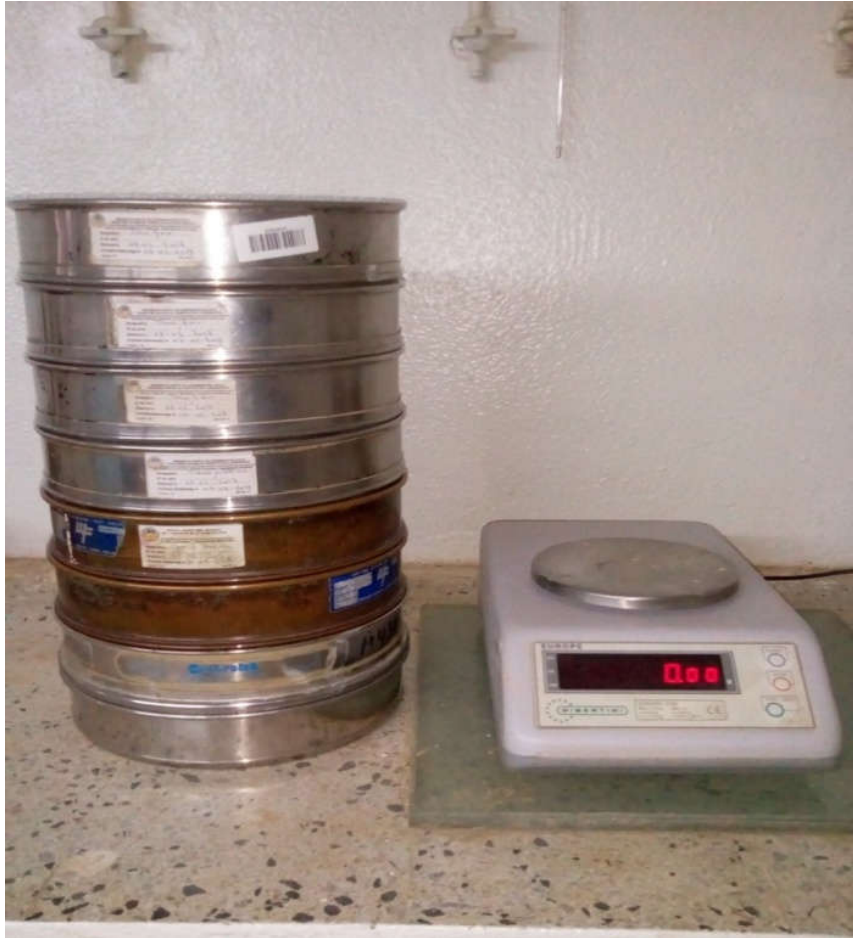
Figure 14 : Essai d'analyse granulométrique par tamisage réalisé au niveau de LNHC.
