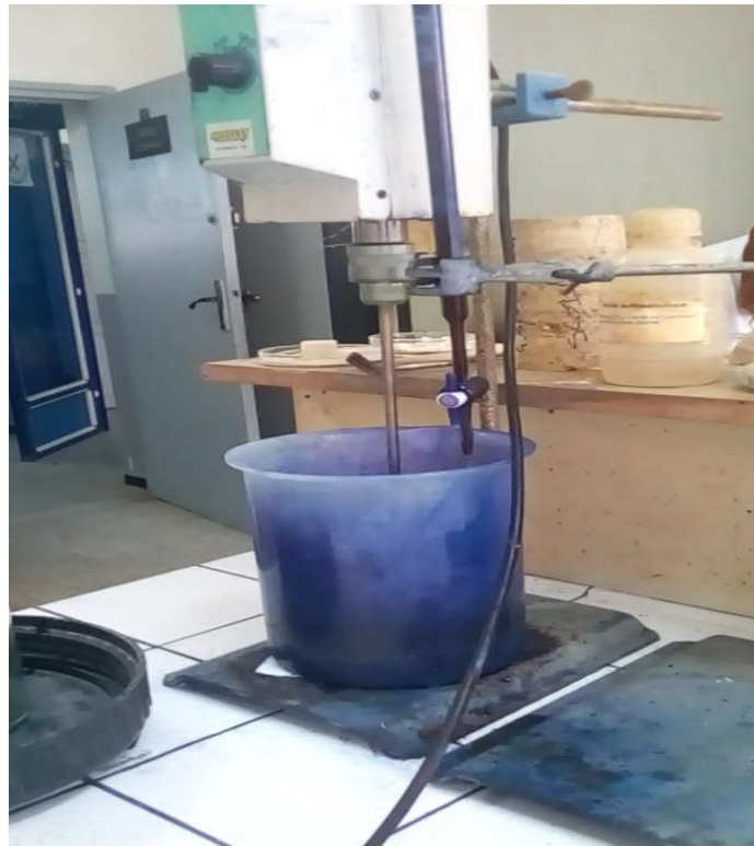
Figure 23 : Déroulement de l'essai VBS.
