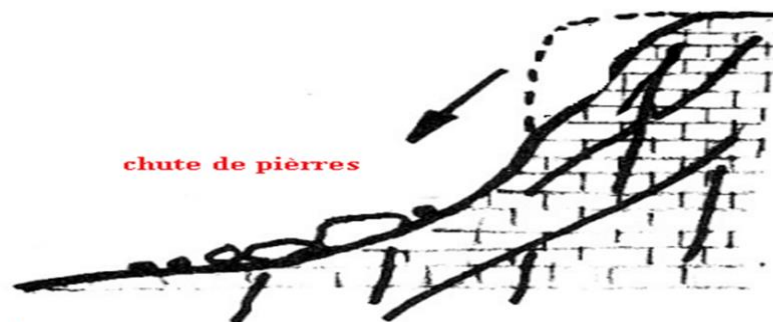
Fig. 1 : Écroulement rocheux par dislocation interne
