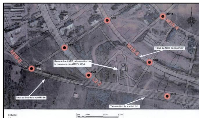
Figure II-4: Plan d'implantation des sondages carottés [LNHC, 17]
