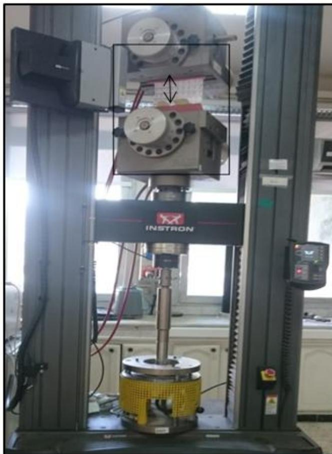
Figure III-4: Photo d'une mise en place des bandes de géotextile dans les mâchoires de la machine de traction
