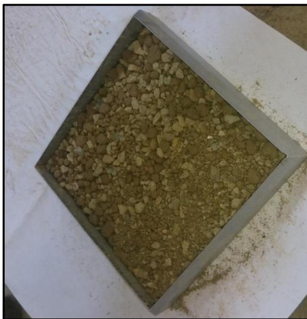
Figure III-16: matériau compacté dans la boîte de cisaillement
