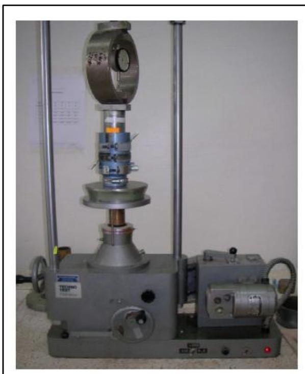
Figure III-7: Confection des éprouvettes par compactage statique
