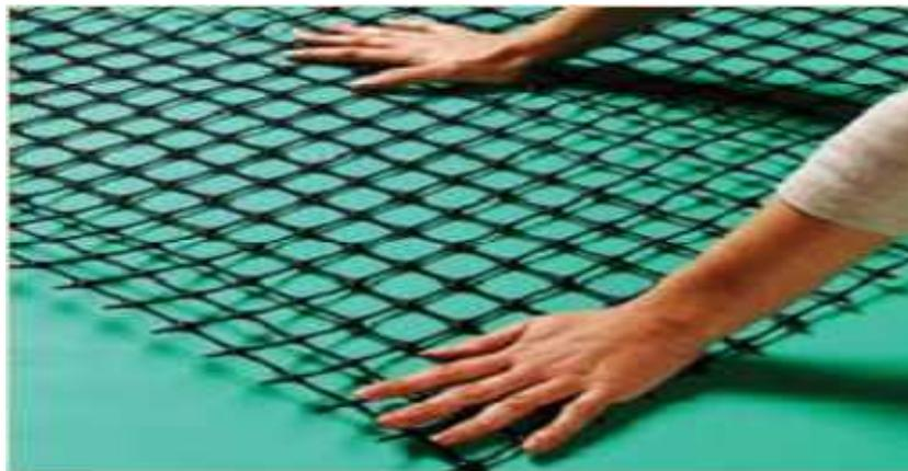
**Figure 9.**Exemple de géogrille biaxiale
