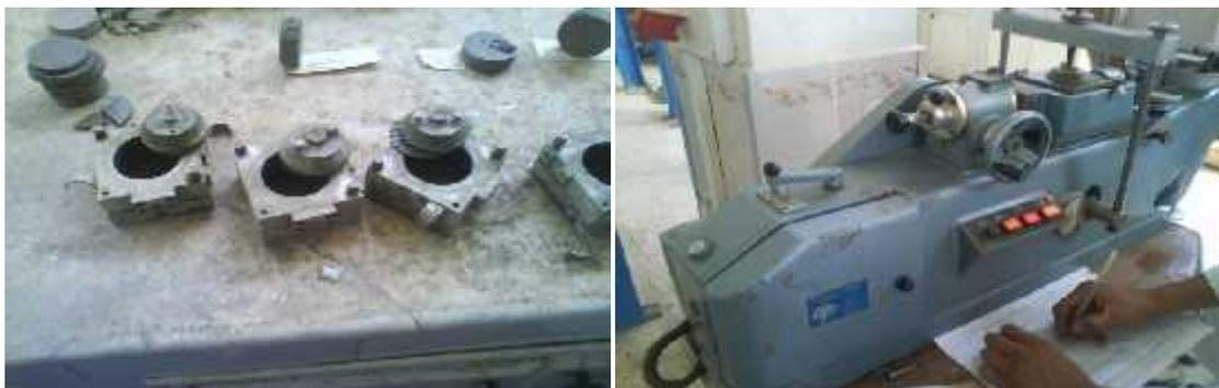
**Figure 26.** Essai de cisaillement
