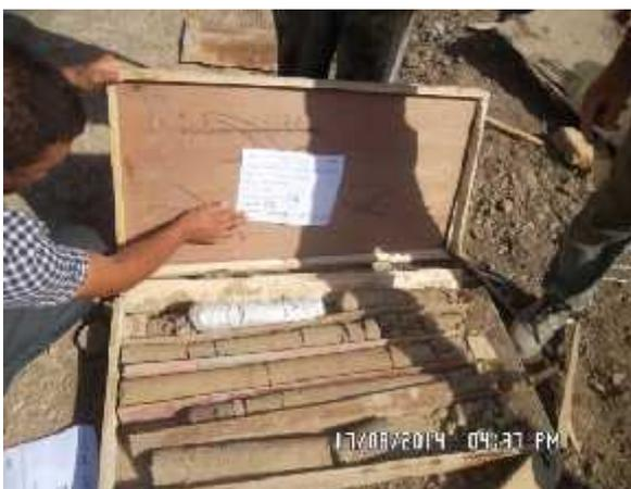
**Figure 12.** Etalage des caisses du sondage carotté 2 entre 20.00-25.00m (SC2)
