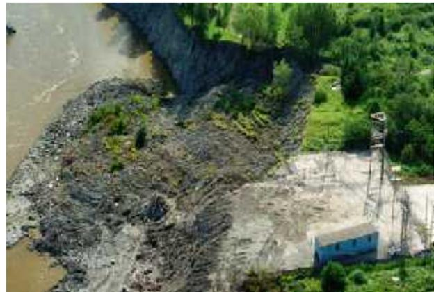
(a) : Mécanisme d'un glissement Rotationnel (b) : Exemple d'un glissement rotationnel multiple En bordure de la rivière Chicoutimi. Complexe.
