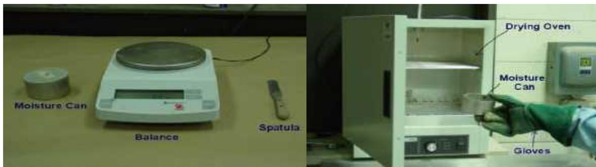
**Figure 21.** Appareillages pour mesure le Poids volumique et Teneur en eau naturelle
