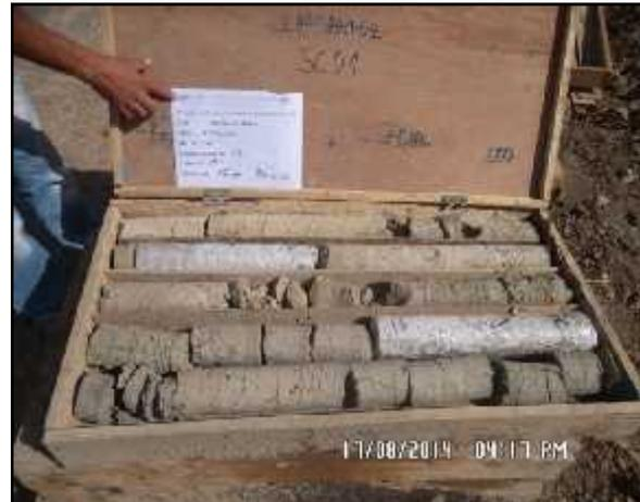
**Figure 11.** Etalage des caisses du sondage carotté 1 entre 15.00-20.00m (SC1)
