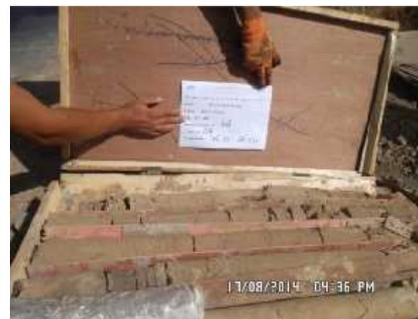
**Figure 13.** Etalage des caisses du sondage carotté 2 entre 15.00-20.00m (SC2)
