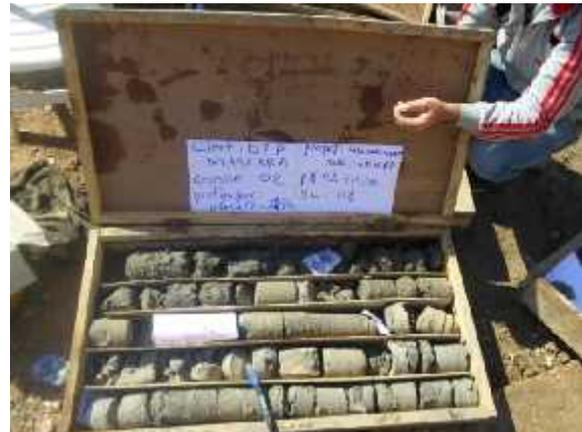
**Figure 14.** Etalage des caisses du sondage carotté 1 entre 00.00-06.50 m
